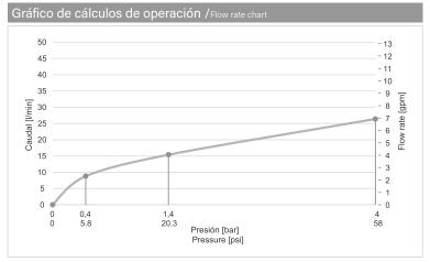
La medición de caudal fue realizada con la salida del cuerpo libre de restricciones. Flow measurement was performed with body water oulet free of restrictions.
